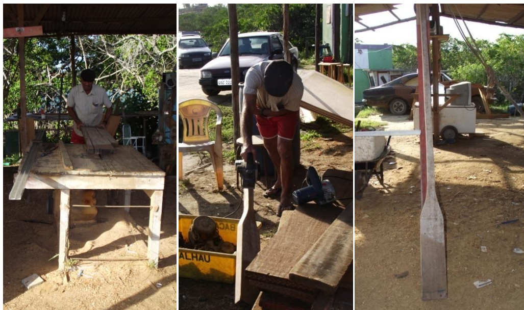
Figuras 20, 21 e 22—Onofre riscando, cortando e dando acabamento a tábua que seria um remo. Fonte:Graziéli, 2016.
