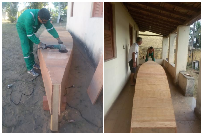
Figuras 96 e 97- Fagner lixando a bateira e depois de lixada, a colocando na varanda com Laudo Fonte: Graziéli, 2016
