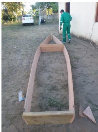
Figura 92 – A bateira depois de colocada o arco Fonte: Graziéli, 2016
