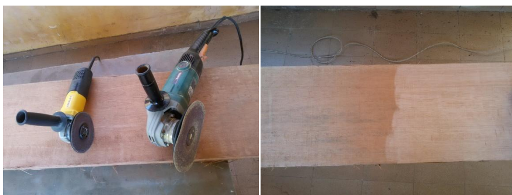
Figura 84 e 85 - Lixadeira e esmerilhadeira utilizadas para lixar as tabuas. Na figura esta a tabua com a metade lixada e metade sem lixar.
