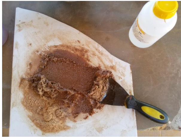
Figura 99- Cola sendo preparada com pó da madeira para a colagem da bateira Fonte: Graziéli, 2016
